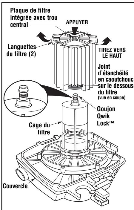
**REMARQUE :** le filtre est fait de matériau de qualité élevée conçu pour intercepter les petites particules de poussière. Le filtre peut être utilisé pour l'aspiration de débris solides ou liquides. Manipuler le filtre avec précaution lors de son nettoyage ou de son installation. Les plis du filtre peuvent être froissés pendant l'installation, mais cela n'aura aucune influence sur la performance du filtre.
