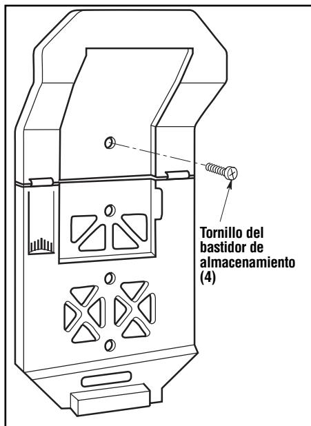
**▲ PRECAUCIÓN:** Para evitar que la madera contrachapada, el bastidor de almacenamiento o la aspiradora para mojado/seco se caigan, asegúrese de haber seleccionado el elemento de sujeción de longitud apropiada para montar firmemente el bastidor de almacenamiento en la pared.
