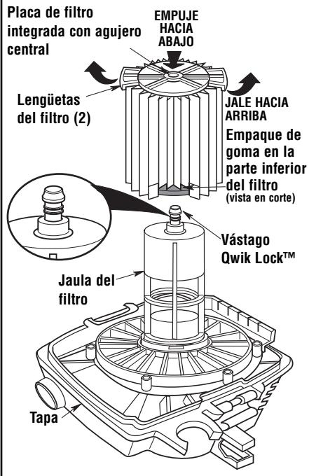
**NOTA:** Este filtro está hecho de papel de alta calidad diseñado para detener partículas de polvo muy pequeñas. El filtro se puede utilizar para recoger material mojado o seco. Maneje el filtro cuidadosamente cuando lo quite para limpiarlo o cuando lo instale. Es posible que se formen arrugas en los pliegues del filtro como resultado de la instalación, pero las arrugas no afectarán el rendimiento del filtro.
