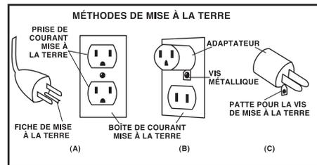
AU CANADA, L'UTILISATION D'UN ADAPTEUR PROVISOIRE N'EST PAS AUTORISÉE PAR LE CODE ÉLECTRIQUE CANADIEN. Assurez-vous que l'appareil est relié à une sortie ayant la même configuration que la prise. Aucun adaptateur ne devrait être utilisé avec cet appareil.
