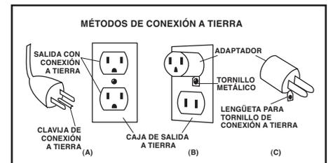
EN CANADÁ, EL REGLAMENTO DE ELECTRICIDAD CANADIENSE NO PERMITE EL USO DE UN ADAPTADOR PROVISIONAL. Asegúrese de que este artefacto esté conectado a una toma de corriente que tenga la misma configuración que la del enchufe. No se debe utilizar ningún adaptador con este artefacto.
