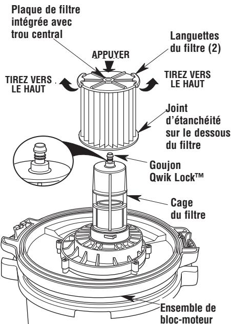
**REMARQUE :** Si vous n'installez pas correctement le joint d'étanchéité du dessous, il est possible que des débris passent à côté du filtre.
